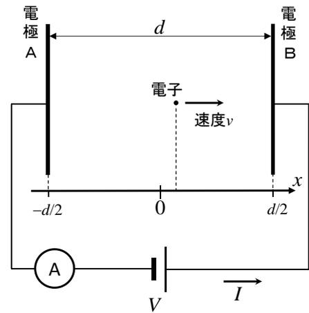
図のように、間隔  $d$  で配置した平行板電極 A, B 間に、一定の電圧  $V (> 0)$  を印加すると、電極板に垂直で一様な電界が生じる。ここで、電極板に垂直な座標軸  $x$  を図の方向に定め、電極間の中点を  $x = 0$  と定める。1 個の電子が時刻  $t = 0$  において位置  $x = 0$  に速度  $v = 0$  で存在するものとする。時刻  $t > 0$  における電子の位置を  $x$  とし、電界から受ける力を  $d, V$  等で表すと、ニュートンの運動方程式は次のように表される。  $m_0 \frac{d^2 x}{dt^2} = ( \text{①} )$  .
