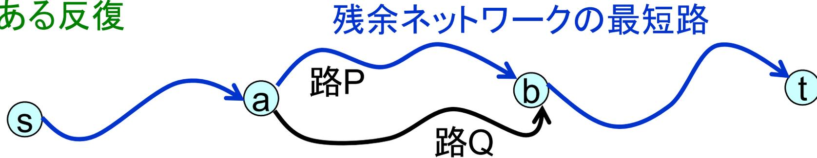
路Pは最短路の一部  $\therefore$  路Pはa から b への最短路
