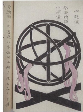
渋川春海が用いた渾天儀 直径二尺（約60cm） 「測量諸器図巻」 （国立天文台蔵）より
