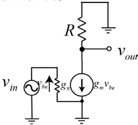
ここで、注意すべきは、直流電圧源は、電圧が変化しないことから、取り除いて短絡すべきことである。（一方直流電流源では電流が変化できないので、取り除くときは開放にする。）
