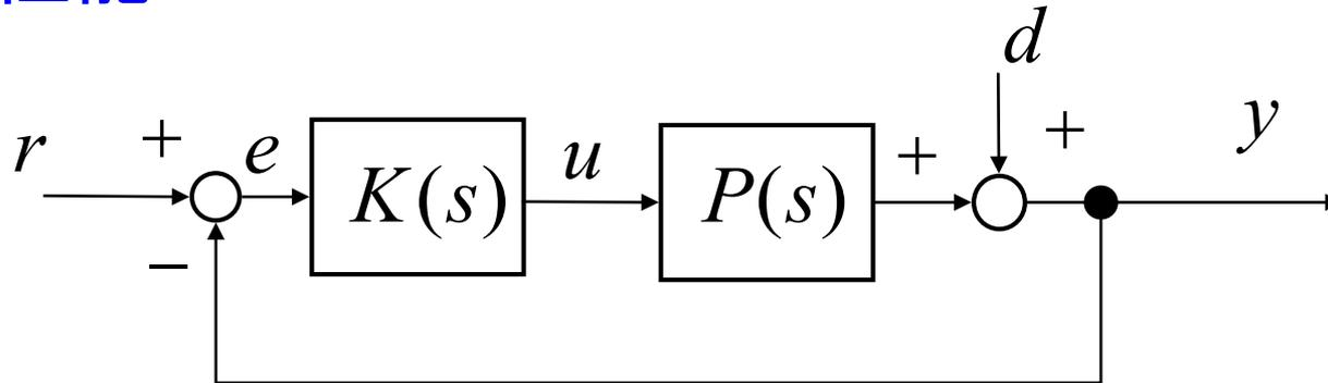
図 7.13 フィードバック制御系
