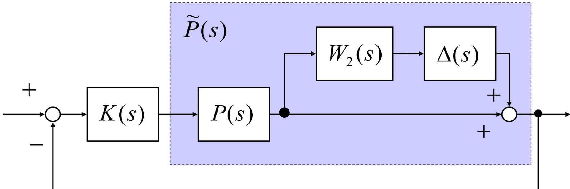
図 7.9 乗法的な不確かさを有するフィードバック系
