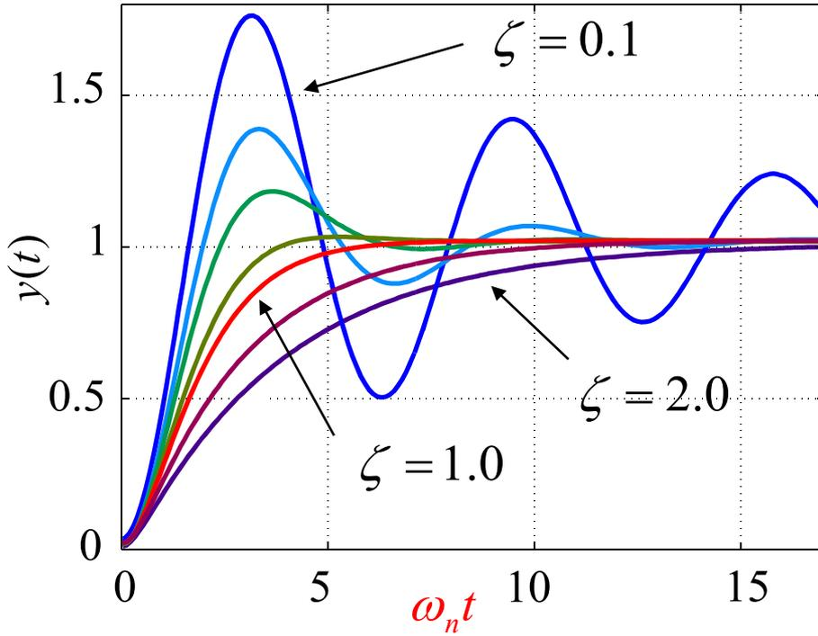
図3.7 2次系のステップ応答
