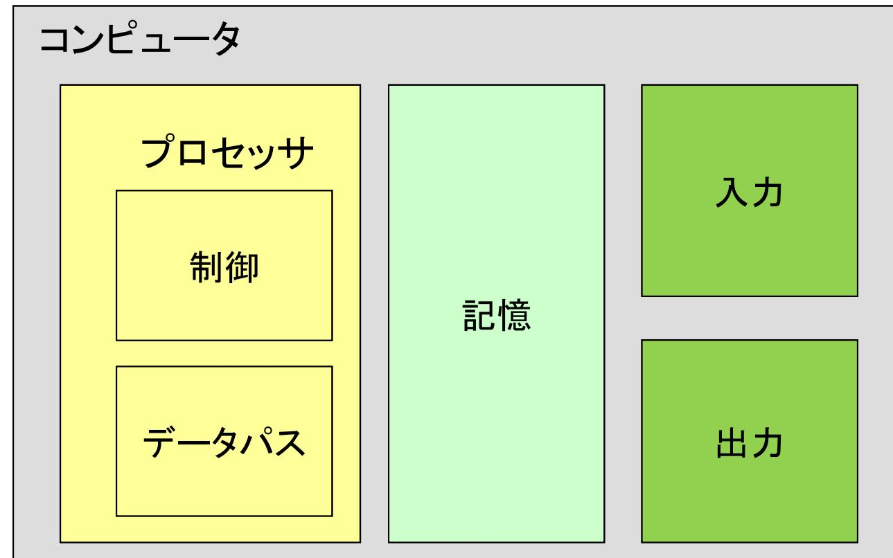
プロセッサは記憶装置から命令とデータを取り出す。入力装置はデータを記憶装置に書き込む。出力装置は記憶装置からデータを読みだす。制御装置は、データパス、記憶装置、入力装置、そして出力装置の動作を指定する信号を送る。
