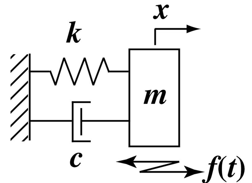
時刻 0 に単位インパルス加振された時の減衰自由振動波形を  $h(t)$  とする。
