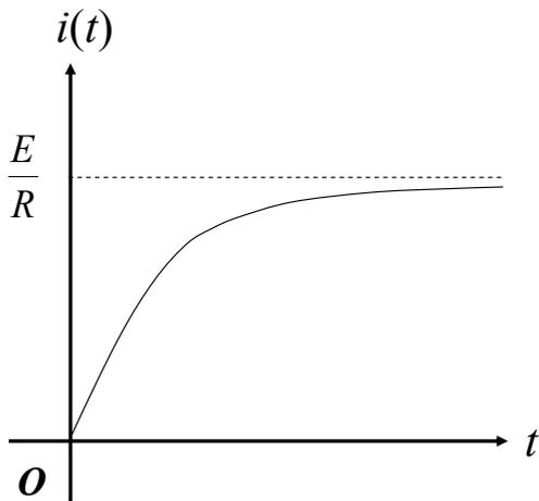
図6 図5の電流(直流電圧源)
