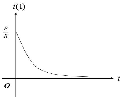
図2 図1の電流(直流電圧源)
