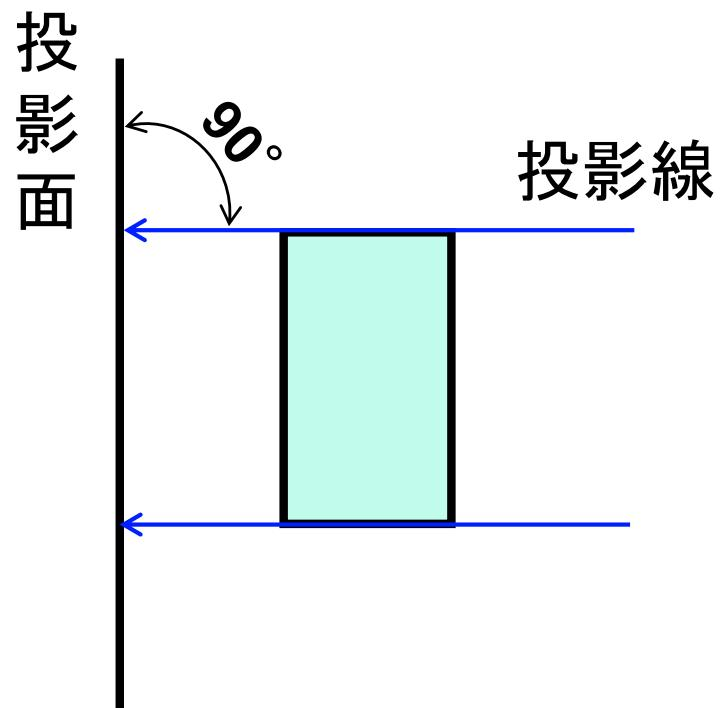
正投影：投影面に実際の長さが反映されるように立体を配置。
