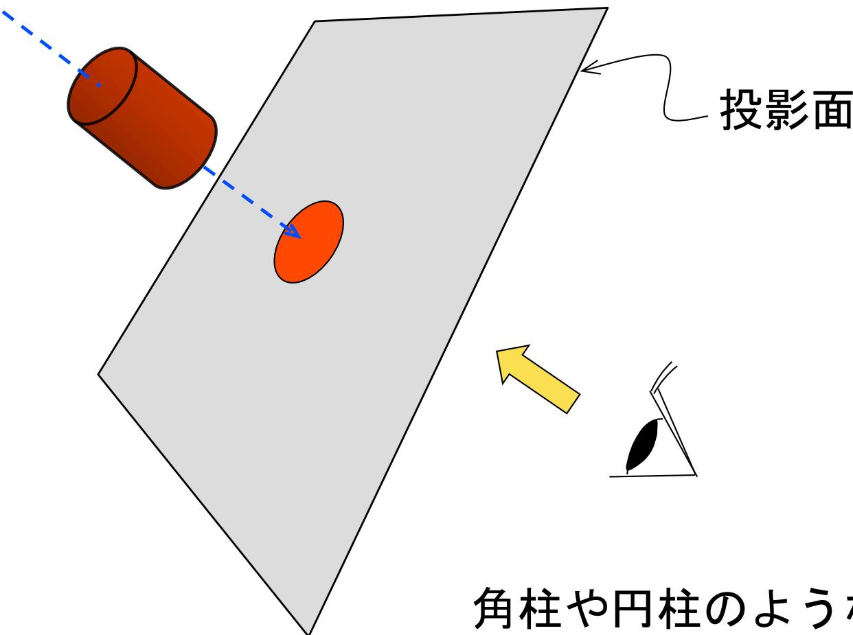
角柱や円柱のような柱状の立体を軸方向と垂直に投影面を設定すると立体の断面形状が投影される。
