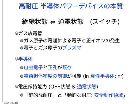
(配付資料 2016 #2-p.1) 高田 ガス放電管は自己遮断できない。 電荷担体:自由電子と正孔。
