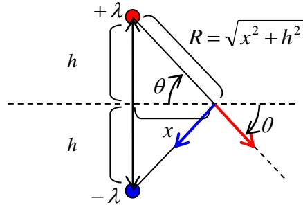
上図より、線電荷の垂直位置より  $x$  離れた位置での電界の垂直成分は、
