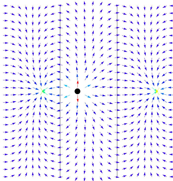
30'. 二つの点電荷間の力について導体板を近づけるとどう変化するか調べよう。具体的に考えるため、小さな導体球が二つ、表面が滑らかな厚さ  $L$  の絶縁体（誘電率は真空と同じ）の上に距離  $d$  だけ離れて置かれ、それぞれ電荷  $Q$  を帯電している。絶縁体の下に無限大に広い導体がある場合と無い場合とで導体球に働く力をそれぞれ求め、どのように力が変化したか答えよ。（図は導体がある場合。導体があるときは映像電荷を置き導体を取り除く。）
