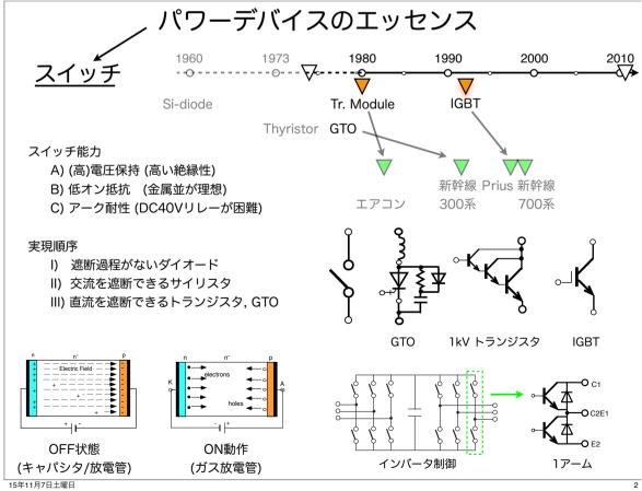
(配付資料 2015 #2-p.2c) 制御理論が重要な訳!(GTO構成図を修正) システム屋には、パワーデバイスは単なるスイッチ (それが正解)。 リレーを使ってもインバータは出来る。還流ダイオードは必要。
