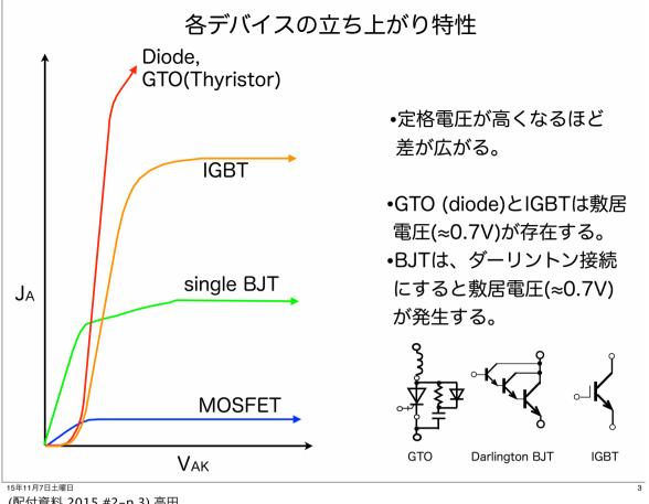
(配付資料 2015 #2-p.3) 高田 敷居電圧: GTO, IGBTはpinダイオード動作に負う。 ダーリントントランジスタは、前段のVecに負う。
