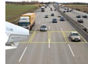
4車線までの同時計測が可能なカメラ装置(Austrian Research Center)
