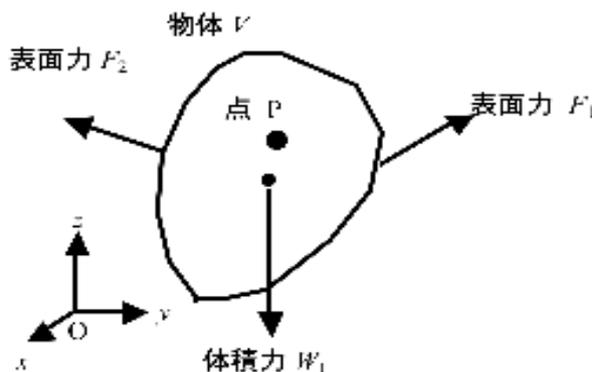
図 3 内部応力状態にある物体  $V$
