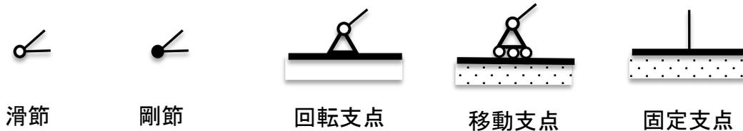
図3 骨組み構造における節点と支点の種類
