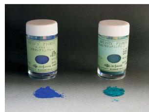
図 3.5: フタロシアニンは環状の二重結合を持つリングが特徴の分子。中心金属が銅の銅フタロシアニンは青色顔料として新幹線のブルーの帯に使われている。周囲の水素を塩素に置換すると色が緑に変化する。フタロシアニン類は有機太陽電池の材料としても注目されている。
