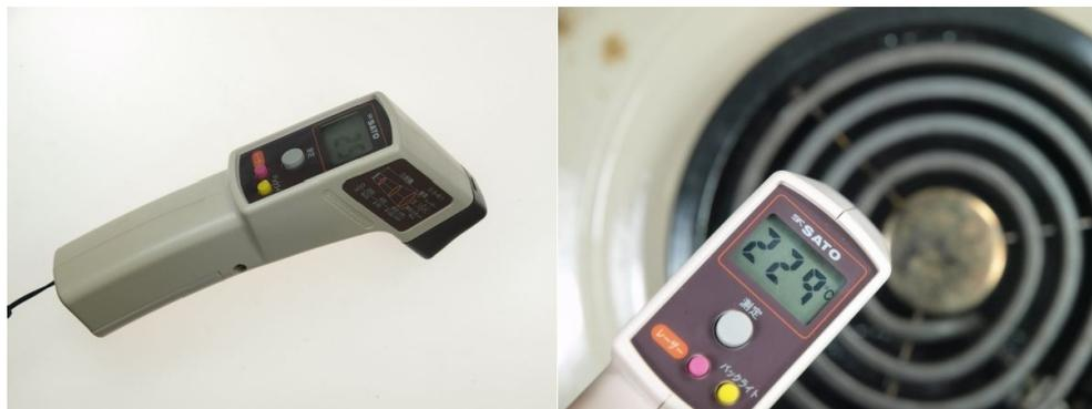
図 1.12: 放射温度計と温度計を用いた測定。家庭用の伝熱ヒーターの表面温度の測定を行っている。見た目は冷えた状態とかわりがないが、すでに 200 °C を越える温度となっている。
