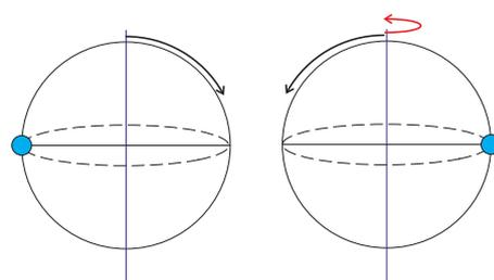
図 3.22: 北極から時計回りに動く粒子も、球体が $180^\circ$ 回転してしまうと、北極から反時計回りに動く粒子になってしまう。
