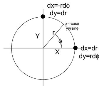
図 3.18: 原点からの角度により  $x$  と  $y$  方向の微小変形の  $r$  と  $\phi$  に対する影響は異なる
