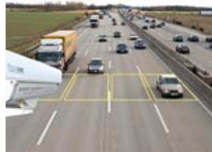
4車線までの同時計測が可能なカメラ装置 (Austrian Research Center)
