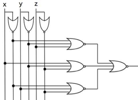
4. 右の図において、 $u = \bar{x}y\bar{z} \vee x\bar{y}\bar{z} \vee xyz$  を実現している回路がすでにあるとき、 $v = \bar{x}\bar{y} \vee \bar{y}\bar{z} \vee \bar{z}\bar{x}$  となるように論理回路 C を追加して、NOT-AND-OR 形式で単純化し、その単純化された論理式を示せ。なお、解答においては、下のカルノー図を利用せよ。
