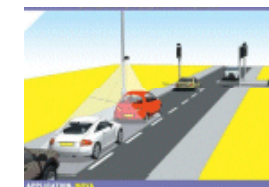
レーダー技術を用いた交通量(量、速度、渋滞、密度)の計測装置のイメージ(AGD Systems)
