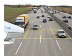
4車線までの同時計測が可能なカメラ装置(Austrian Research Center)
