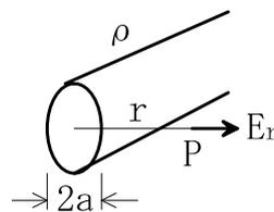
図 1.3: 中空円筒状電荷による電界
