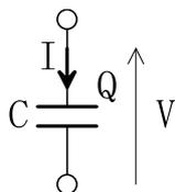
図 1.6: コンデンサーの端子電圧と電流
