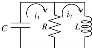
左ループに流れる電流を  $i_1$ , 右ループに流れる電流を  $i_2$  とする。抵抗  $R$  には  $i_1$  と  $i_2$  の差の電流が流れる。
