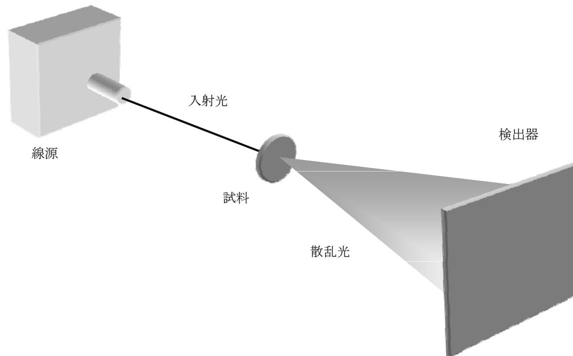
図1 回折・散乱強度測定系の模式図
