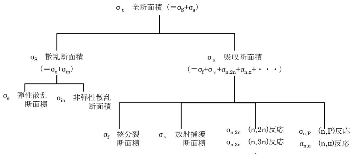
ミクロ断面積は、核種、反応によって異なる。また、入射中性子の速さ (エネルギー) によって変化する。
