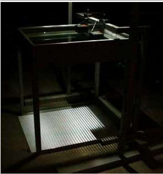
ストロボスコープの点滅の周波数と水波の周波数が同調すると左図のように静止した明暗縞が観察される。この明暗縞の間隔が2cm以下になる周波数領域の水波に対して測定を行う。詳しくは「実験上の諸注意」を参照。
