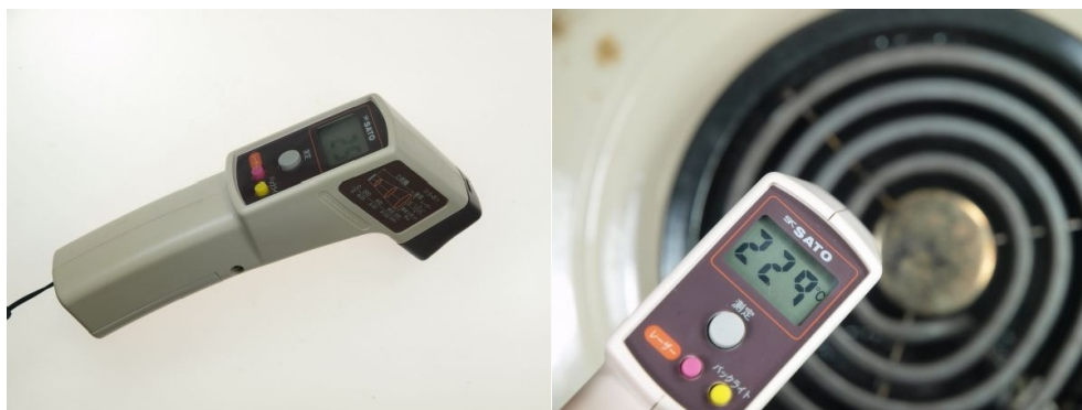
図 1.11: 放射温度計と温度計を用いた測定。家庭用の伝熱ヒーターの表面温度の測定を行っている。見た目は冷えた状態とかわりがないが、すでに 200℃を越える温度となっている。
