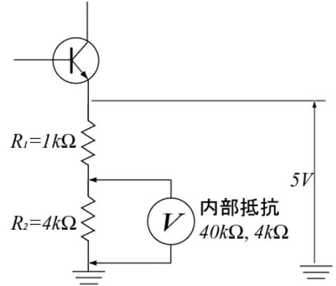
図 1-6 抵抗回路と電圧測定
