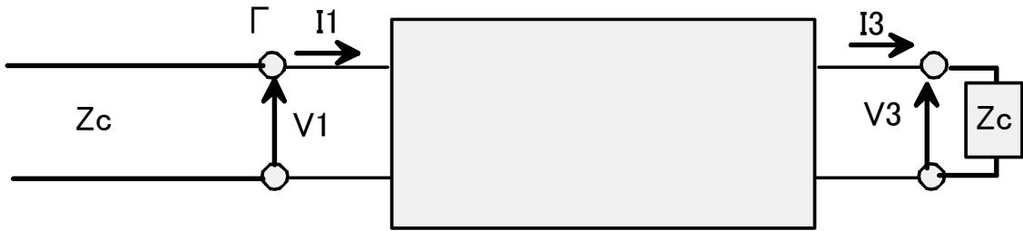
$$\begin{pmatrix} V_1 \\ I_1 \end{pmatrix} = \begin{pmatrix} A & B \\ C & D \end{pmatrix} \begin{pmatrix} V_3 \\ I_3 \end{pmatrix}$$
