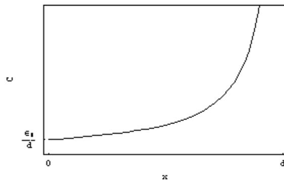
$x$  が大きくなって極板間が狭くなるほど静電容量は大きくなることがわかる。実際の電子部品のコンデンサもできるだけ面積を大きくし、極板間の距離を小さくするように工夫されている。
