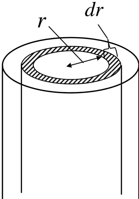
半径  $r$  の円筒側面に作用する力
