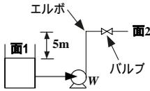
例題2.7: 面2の流速 $u_{a2}$ は面1の流速に比較して大きく、摩擦損失の生じる配管内流速と一致する
