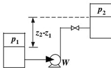
異なる内径の管に対して機械的エネルギー収支により  $W$ , さらに出力  $P_p$  を計算
