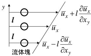
速度変動 $u'_x$ を左図の $l$ 離れた位置にある流体塊の速度の差と見なす
